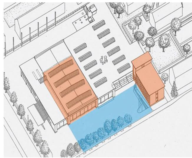
Die geschützten Teile des Depots Deutweg sind in dieser Ansicht farbig markiert, der Rest darf abgebrochen werden. Skizze: PD
